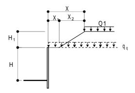
載荷重の換算はフリューリッとの地盤応力の理論を応用し、次式で算定する。
